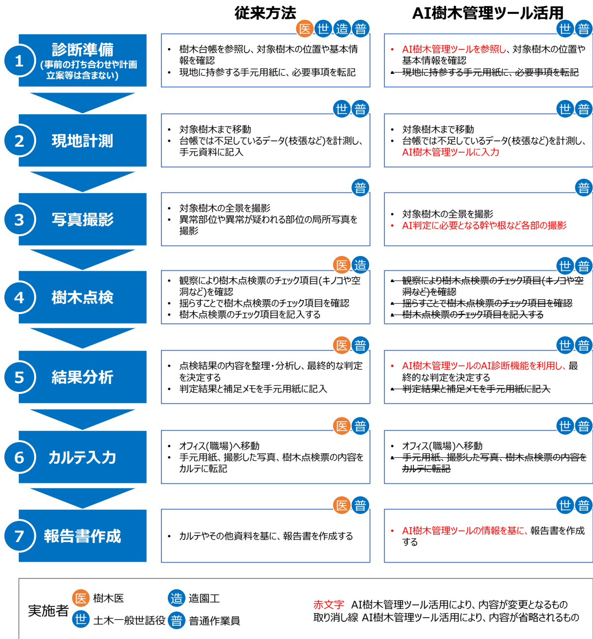
図 4-2 「樹木点検」業務の作業フロー
