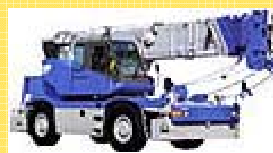
ホイールクレーン (ラフテレーンクレーン)
