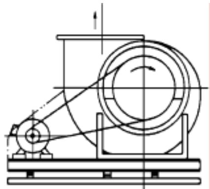
図3-2 多翼形換気ファン（例）
