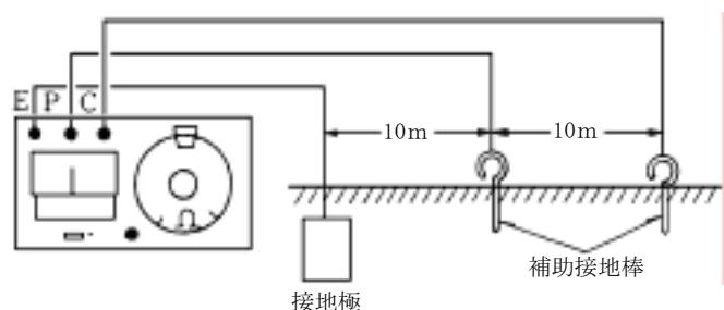
図 6-6 接地抵抗測定回路
