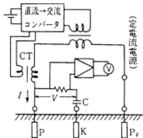
図 6-4 定電流式接地抵抗計
