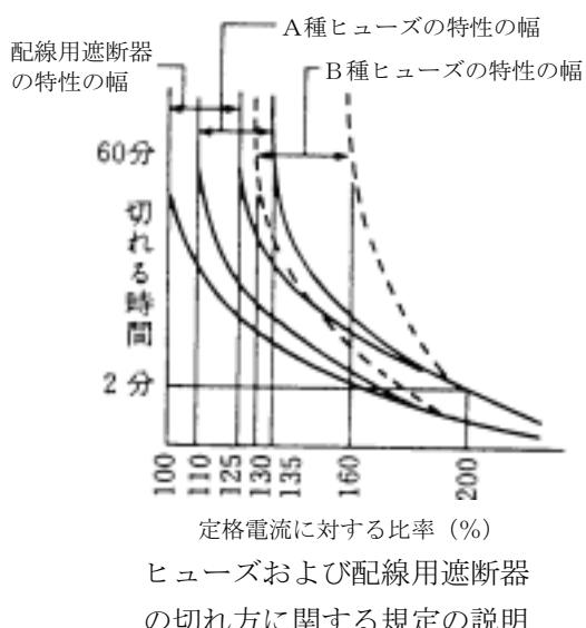
図 7-2 ヒューズ及び配線用遮断器の切れ方に関する規定
