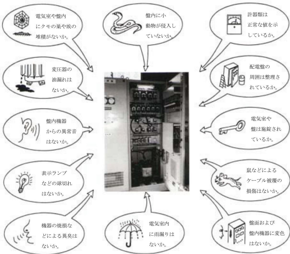
図 6-1 巡回時における監視操作制御設備の点検例
