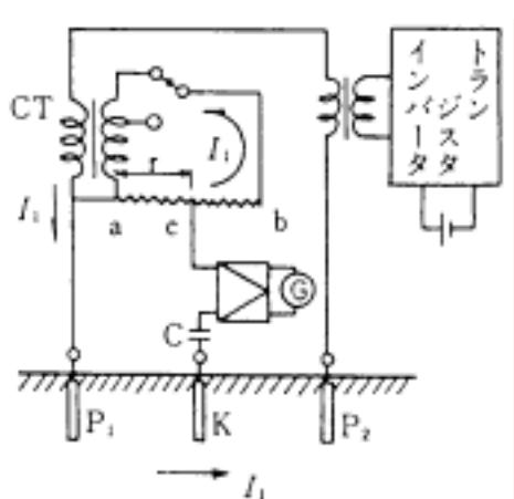
図 6-3 電位差計式接地抵抗計
