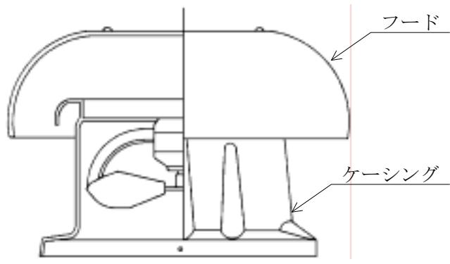
図3-1 天井形換気扇（例）
