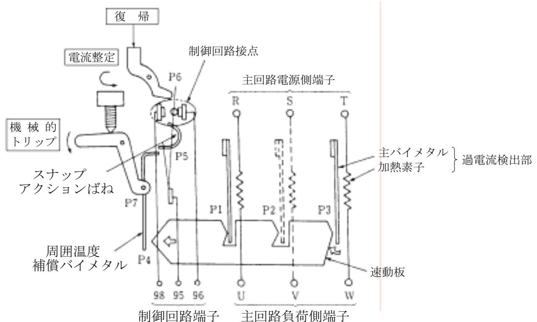
図 6-12 サーマルリレーの原理構造
