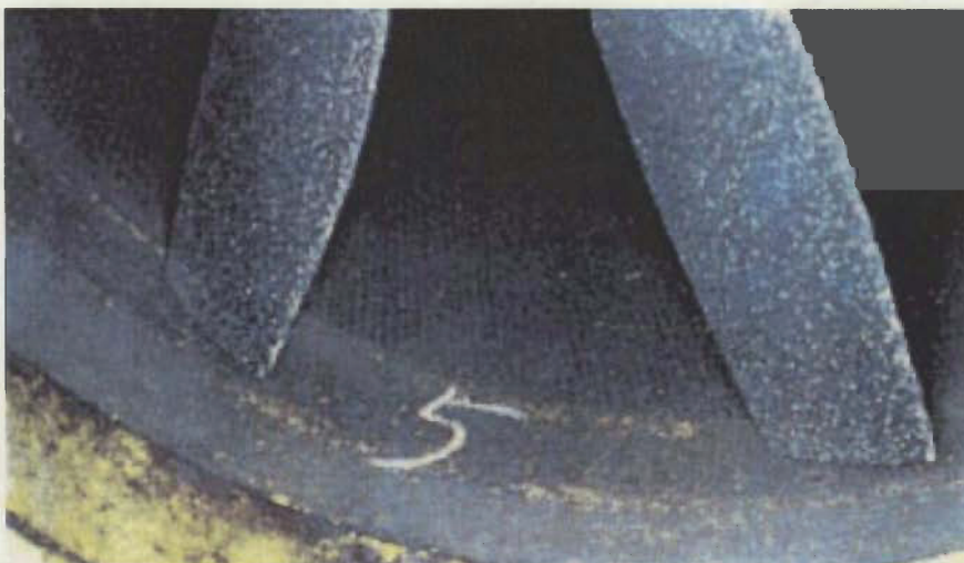
写真－6 羽根車：ダスト付着〔有〕
