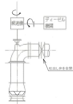
図 3.1-4 締切運転方式の例
