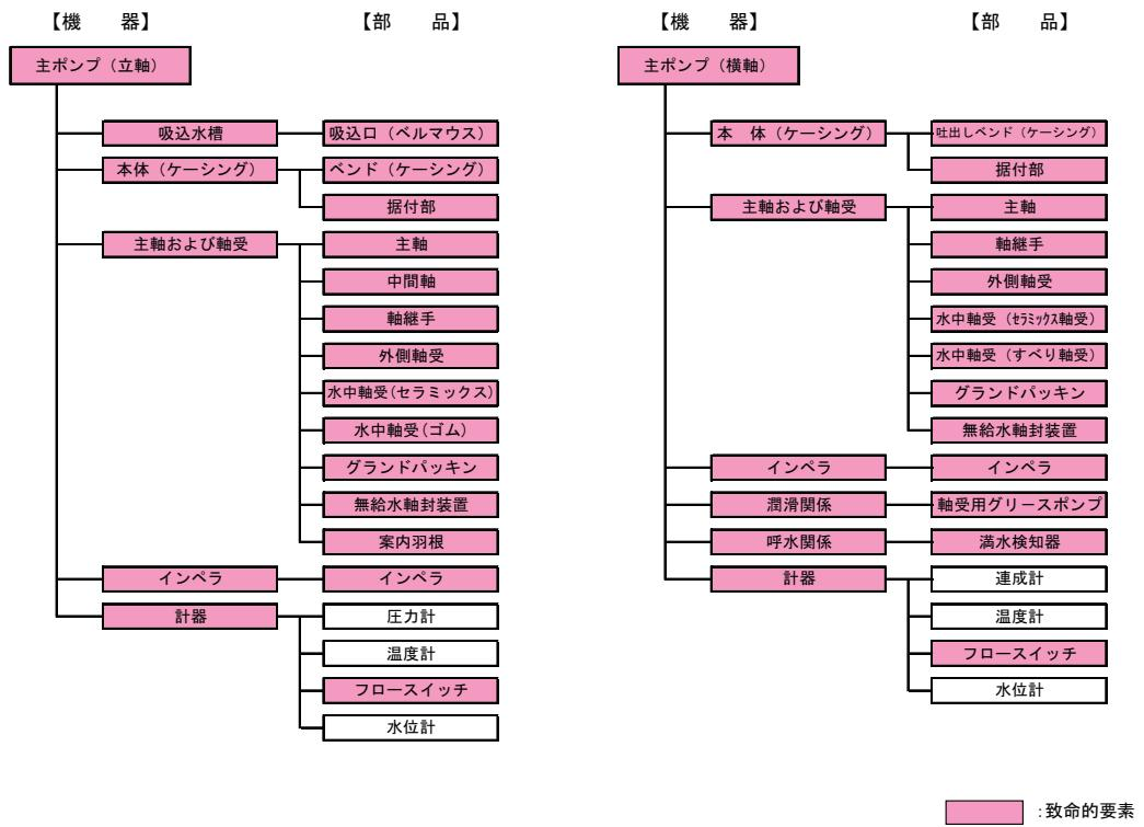
図 2.4-2 河川ポンプ設備の構成要素例（主ポンプ）
