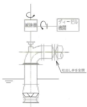
図 3.1-3 バイパス管循環運転方式の例
