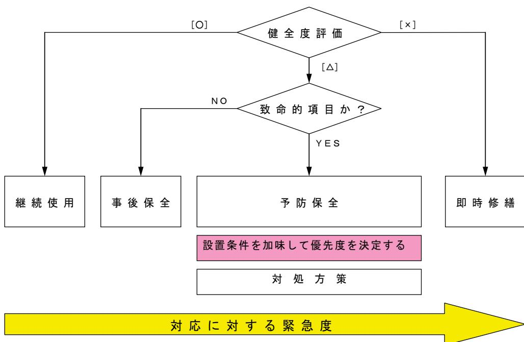
図 4.3-1 設置条件を加味した健全度評価の流れ
