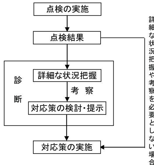
図 3.3-1 点検と装置・機器診断
