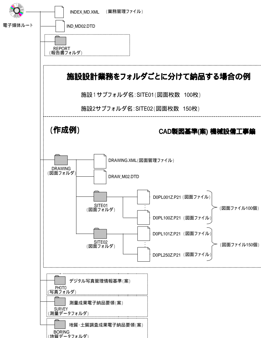
図 2-8 「土木設計業務等の電子納品要領(案)機械設備工事編」でサブフォルダ管理する場合のフォルダ構成例
