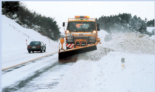
除雪トラックによる作業
