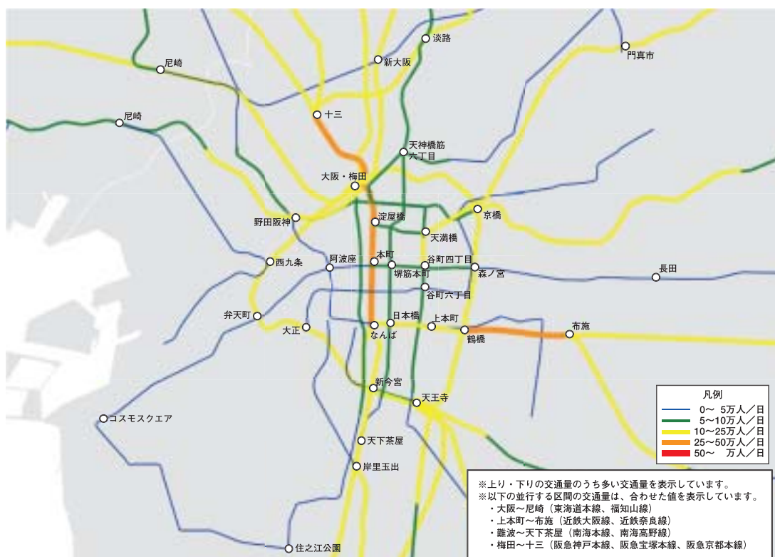
図7 路線別駅間断面交通量(大阪市中心部、終日)
