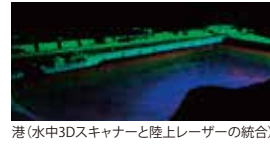
港(水中3Dスキャナーと陸上レーザーの統合)
