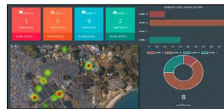
腐食の進む鉄塔を腐食劣化度別に地図上に色分け表示。エリア内の鉄塔の腐食傾向が容易に確認でき、補修工事計画が短時間で策定可能になる。
