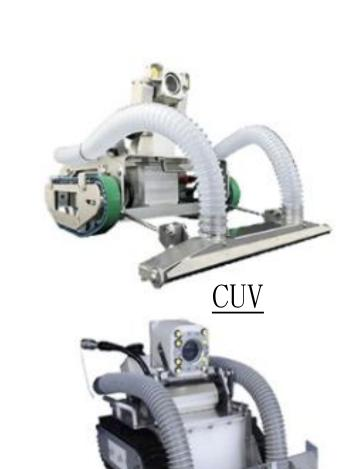
クリア 配水池清掃水中ロボット (型式認定機種)
