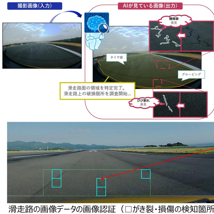
滑走路の画像データの画像認証 (□がき裂・損傷の検知箇所)
