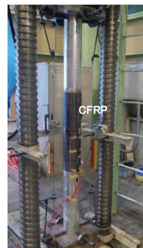
VaRTM補強鋼管圧縮試験
