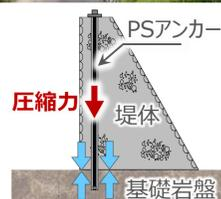
堤体PSアンカー工法概要図
