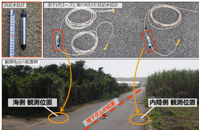
自記水位計の設置方法と観測配置の例
