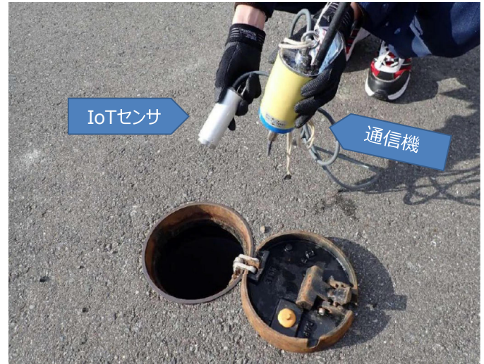
AI搭載のIoTセンサシステム (漏水リスクエリア等の弁栓類に設置)
