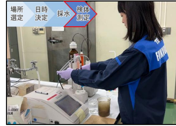
検体の塩化物イオン濃度測定
