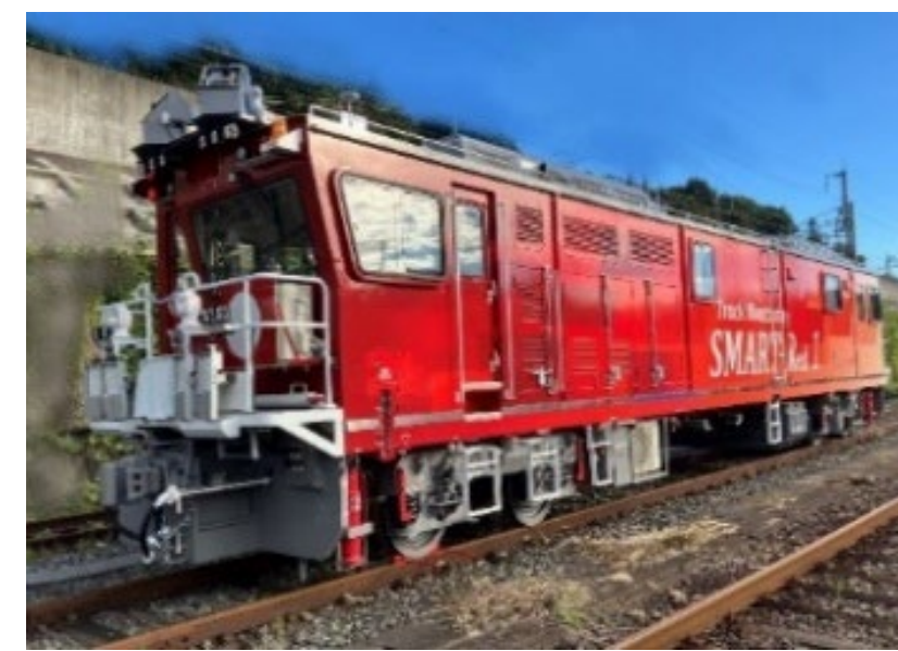
線路設備モニタリング車
