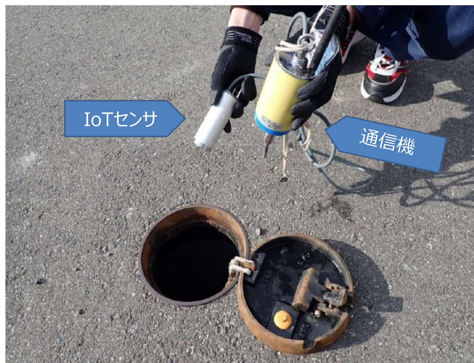
AI搭載のIoTセンサシステム (漏水リスクエリア等の弁栓類に設置)
