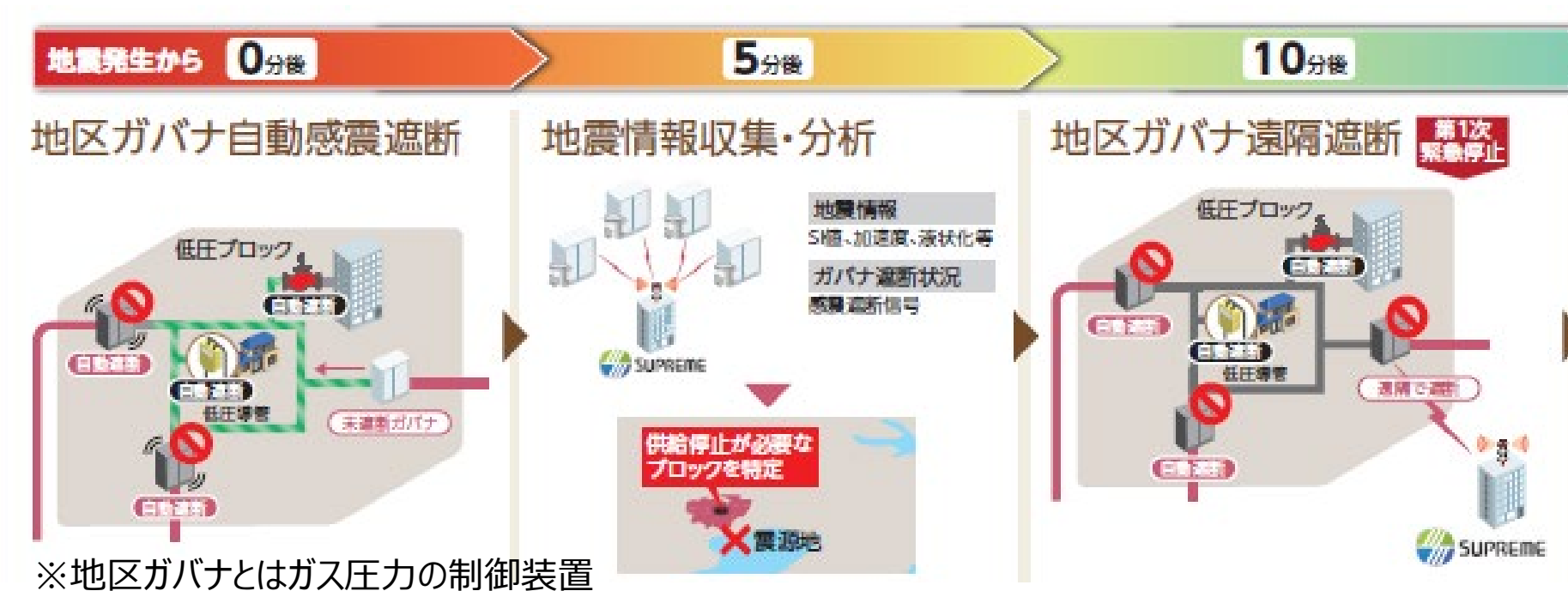
地震発生から第1次供給停止（遠隔遮断）までのフロー
