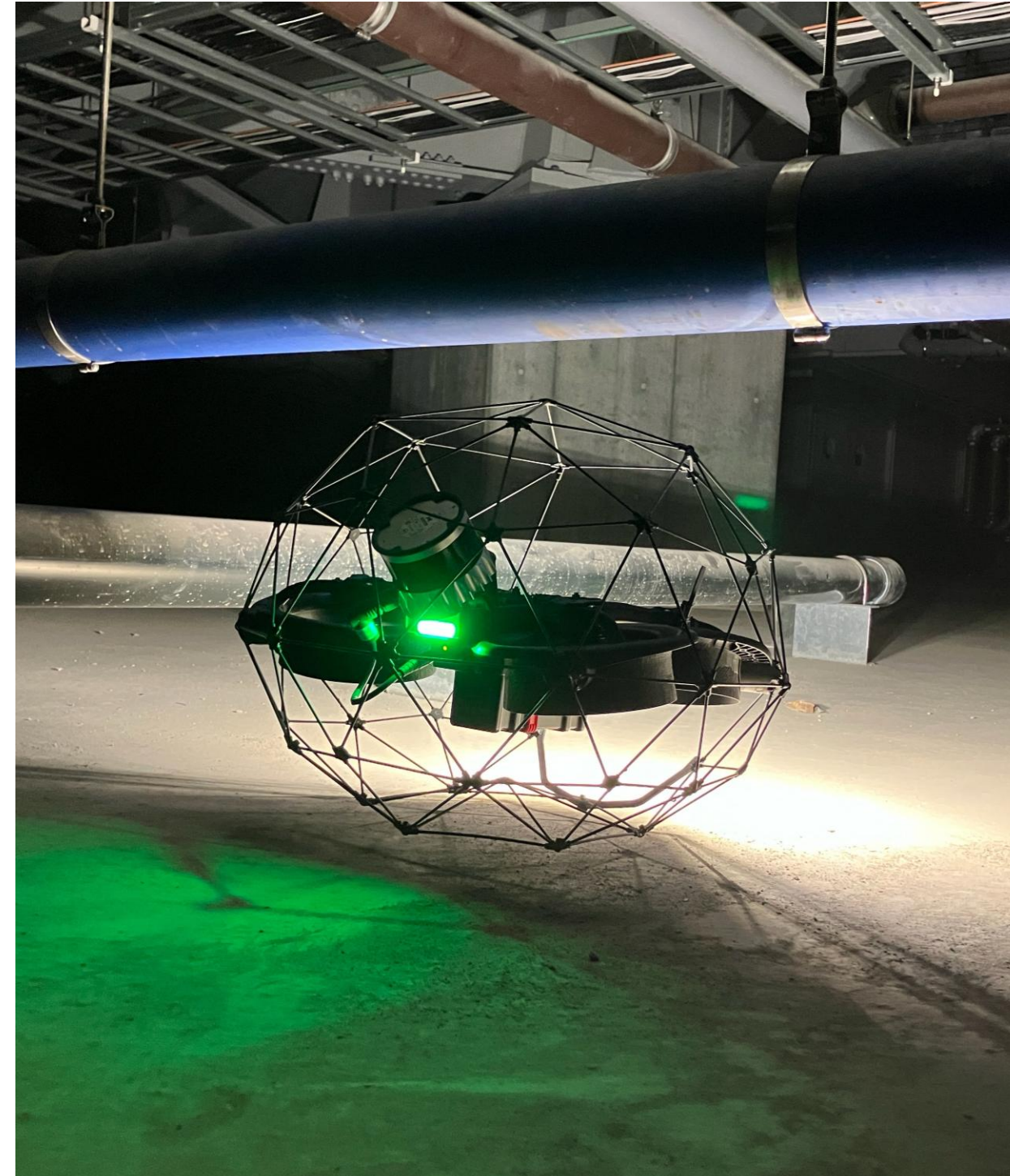
ドローンによる狭小空間の点検例 (ELIOS3)
