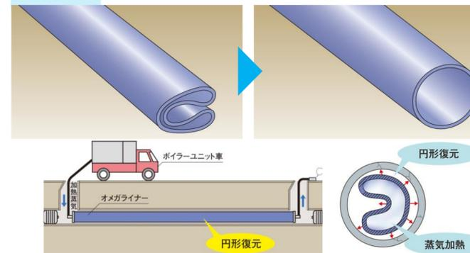
Ω (オメガ) 状に折りたたんだまま既設管内に搬入し、蒸気で加熱することにより円形に復元。圧縮空気により既設管に密着させる。
