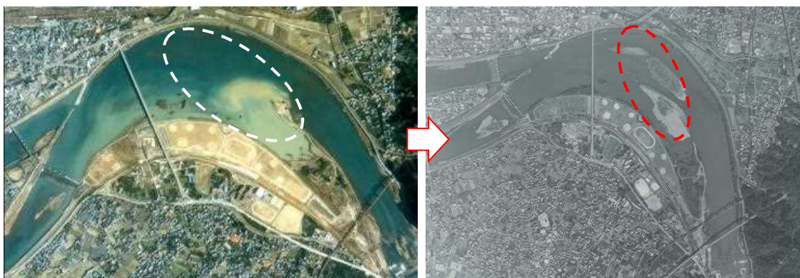
写真 2-54 拡幅後に土砂が再堆積し、川幅が縮小した状況
