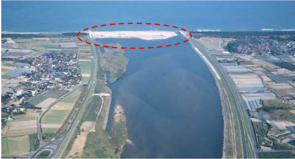
写真 2-60 河口部の砂州発達による河口閉塞
