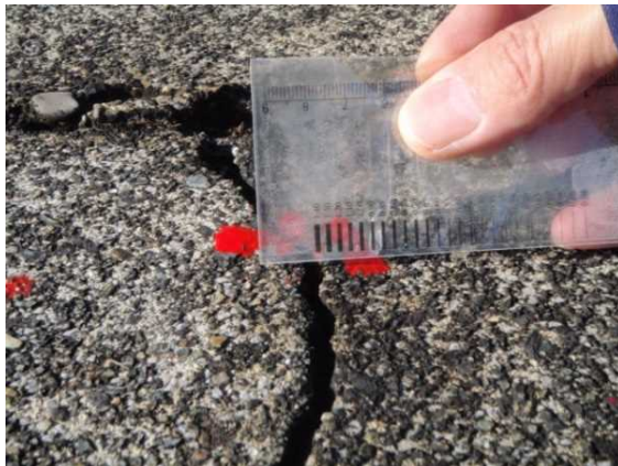
写真 2-20 亀裂幅、目地開き幅の確認状況
