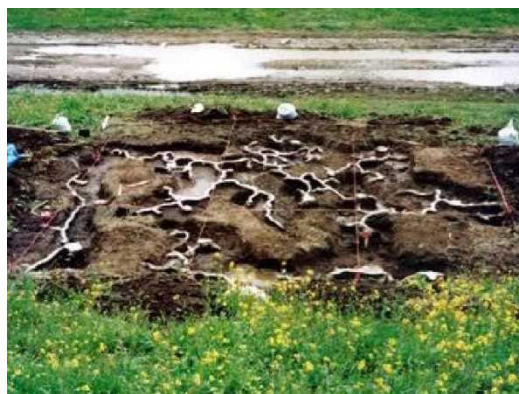
写真 2-10 堤防法面のモグラ塚と、地中のモグラの巣の状況
