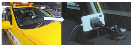
図1 バトロール車に取り付けられたAIスマホ路面判定装置(北区)
