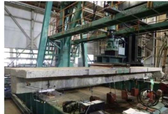
解体後 土木研究所での破壊試験
