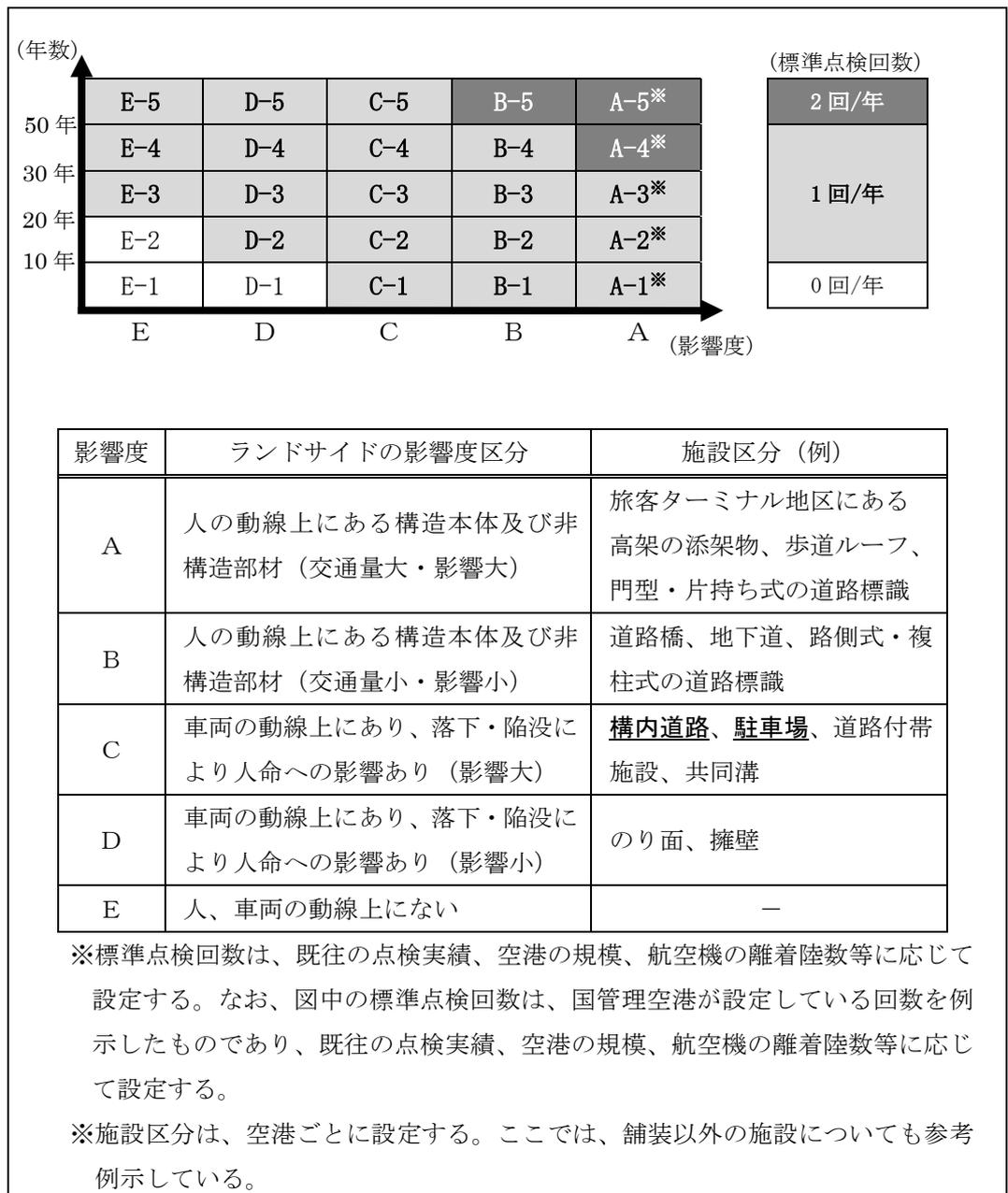
図 4.2.4 基本施設以外 (制限区域外) の巡回点検の標準点検回数の設定
