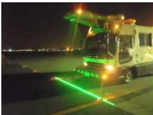
写真 4.4.2 路面性状測定車による調査状況（例）
