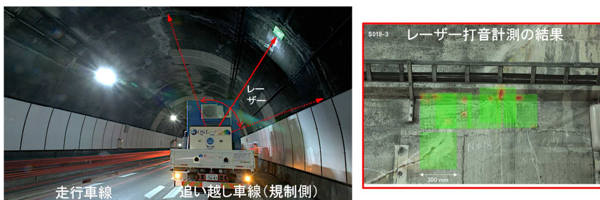
図 レーザー打音計測による計測の様子並びに計測結果
