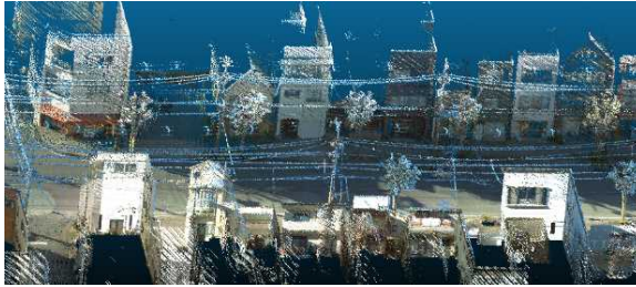
現場試行（日立ソリューションズ）の結果：点群データからの電柱抽出
