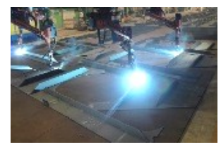
例 3次元図面を基に作業するAI自動溶接ロボットの開発
