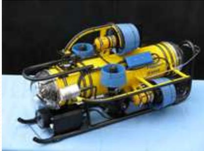
図 三井RTV水中カメラロボット
