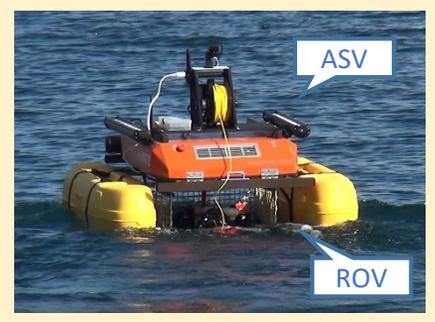
海上を進むASVと内部に収納されたROV
