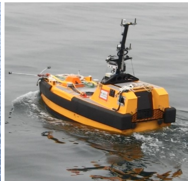
自律型高機能観測装置(ASV) ( A utonomous S urface V ehicle)
