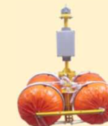
ICTブイ（既設） EC/DO/クロロフィル センサー搭載
