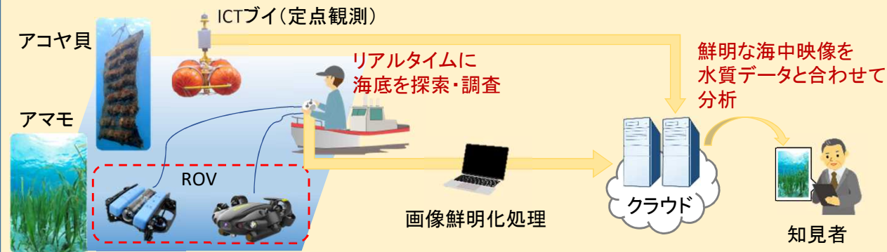
ROV ＜BlueROV＞ 水中カメラ・ 採泥器搭載
