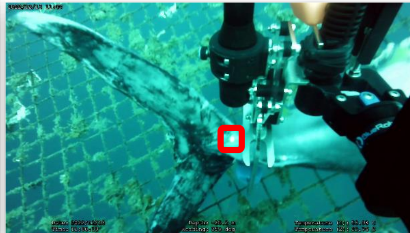
レーザーポインターつき大型へい死魚回収キット（赤枠内照射先）
