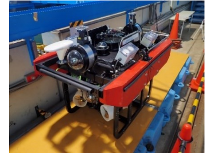
栈橋上部工点検用ROV
