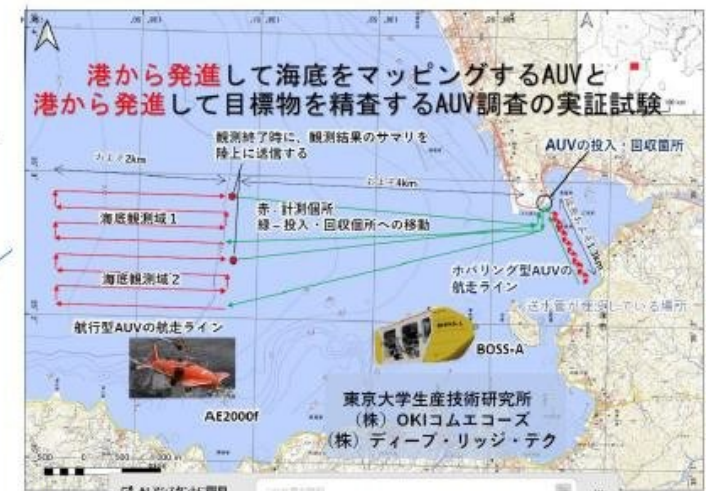
港から発進して海底をマッピングするAUVと港から発進して目標物を精査するAUV調査の実証試験(国立大学法人東京大学生産技術研究所) 3)
