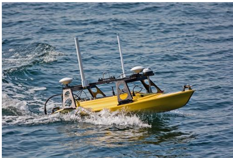
ラジコンボートによる海底地形計測
