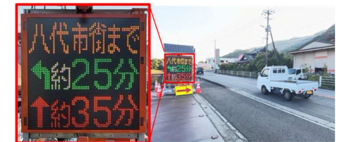
デジタルサイネージによる迂回案内 (国道3号・熊本県八代市)
