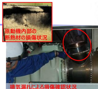
排気漏れによる損傷確認状況
