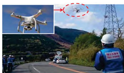
3次元計測機器による被災状況の把握
