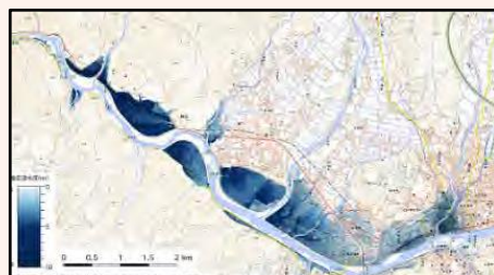
浸水推定図の作成 (令和 2 年 7 月豪雨、球磨川)
