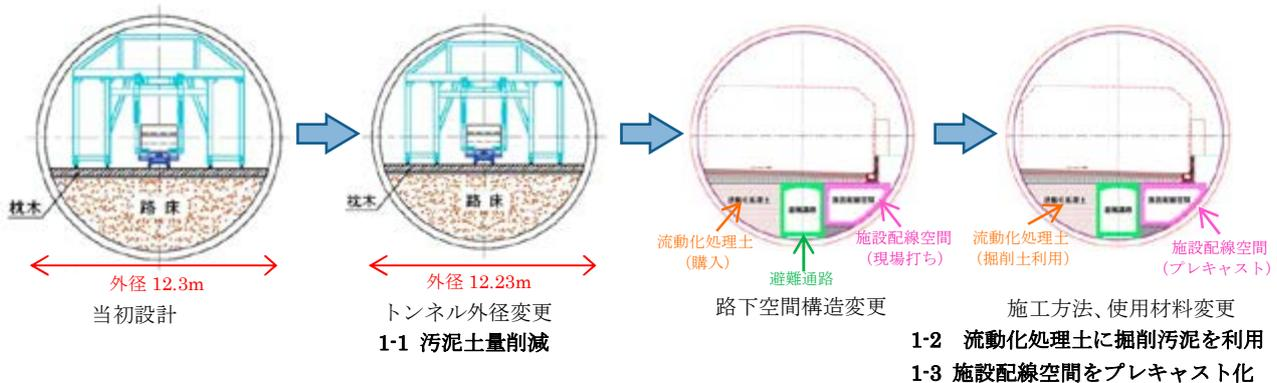
1-1. セグメントの縮径により掘削土量を削減【発生抑制】
