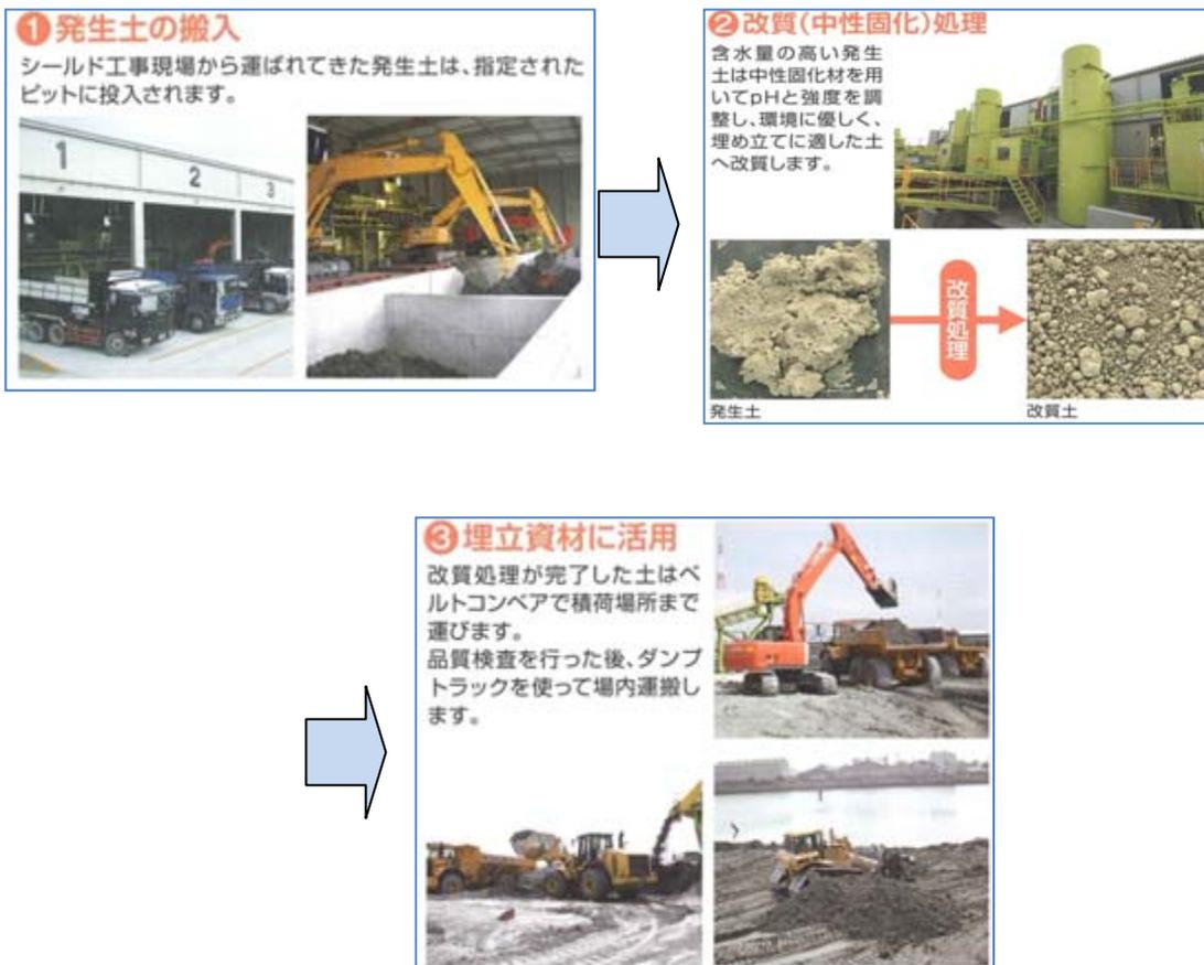
図. 建設汚泥処理の流れ
