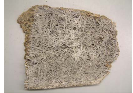
セメント木毛板(セメントとチップの混合材)
