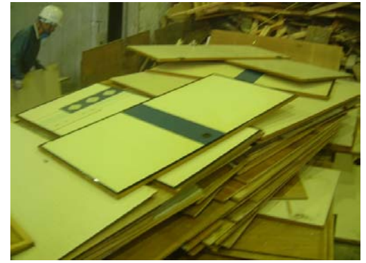
ふすま(板に塩ビクロスが糊付け)
