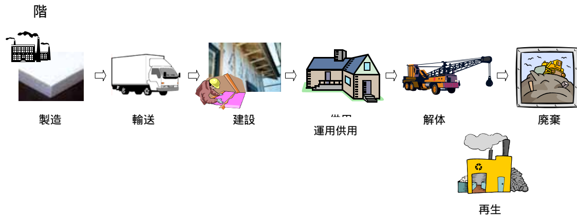
図 4-1 建築用断熱材および開口部材の LCCO 2 算定対象範囲
