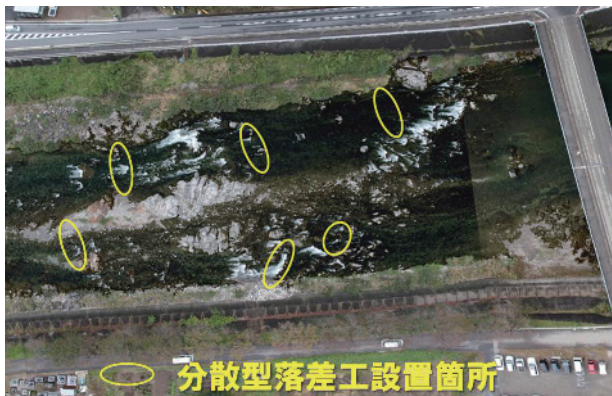
河床低下対策（分散型落差工）の施工位置
