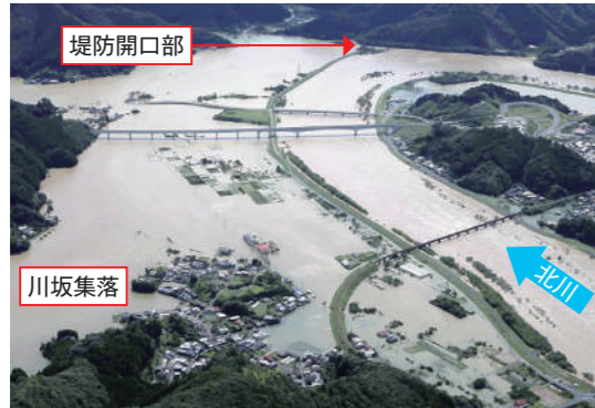
北川の霞堤(別名:信玄堤) 平成28年9月台風16号による浸水状況
