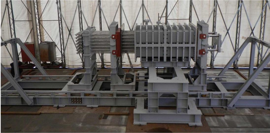
写真-4.14 大型脱水固化装置
