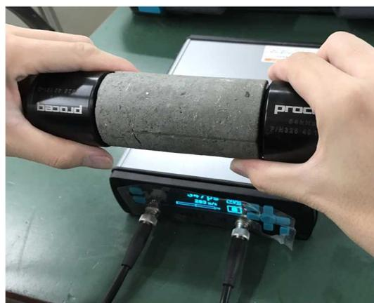
写真-4.44 超音波伝搬速度測定
