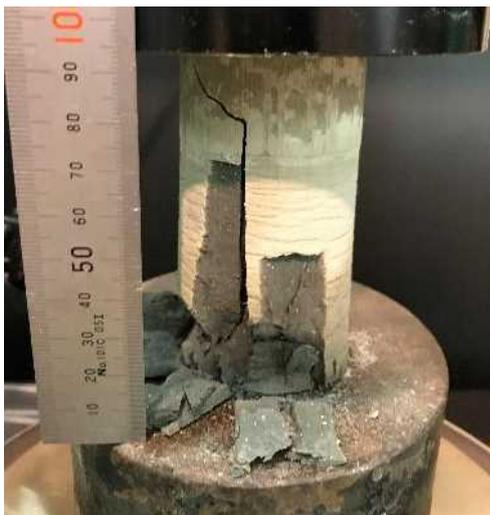
写真-4.33 供試体破壊状況(1)
