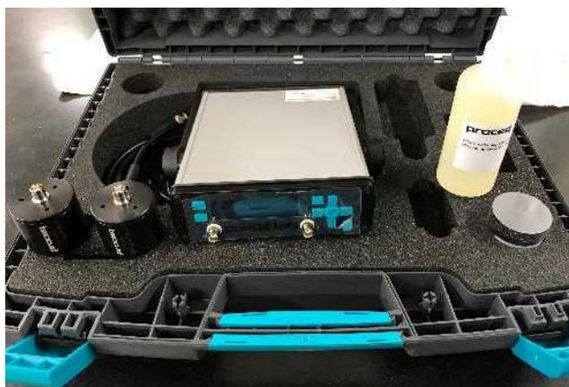
写真-4.43 超音波速度測定装置
