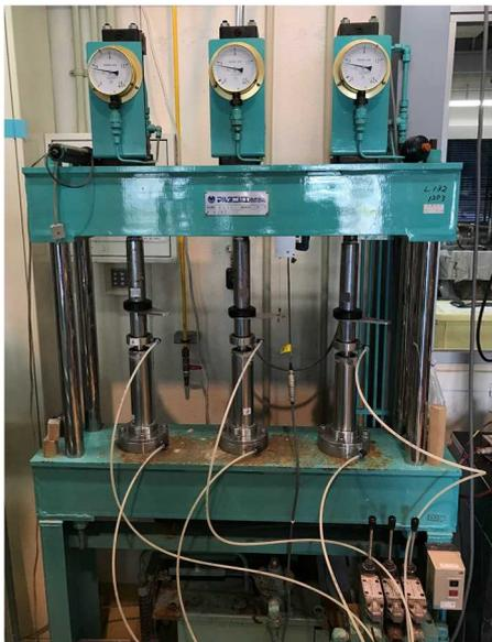
写真-4.3 定圧载荷装置
