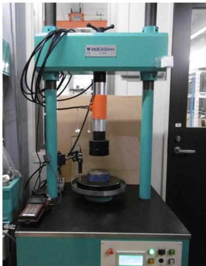
写真-4.28 一軸圧縮試験機
