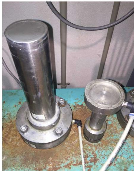
写真-4.4 締め固めモールド
