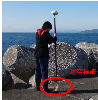
図 4.2 標定点の位置座標の測量
