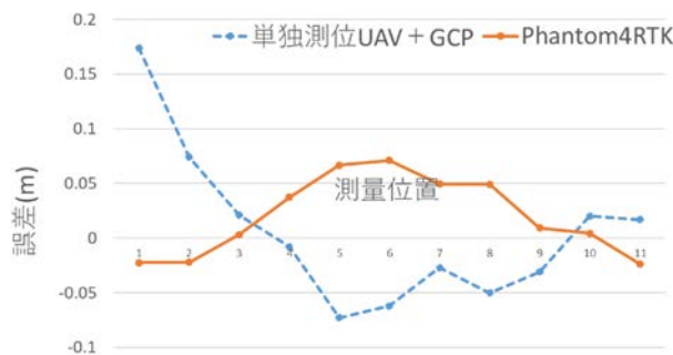
図 4.17 防波堤の高さ方向の測量誤差（高度 40m で撮影した場合）
