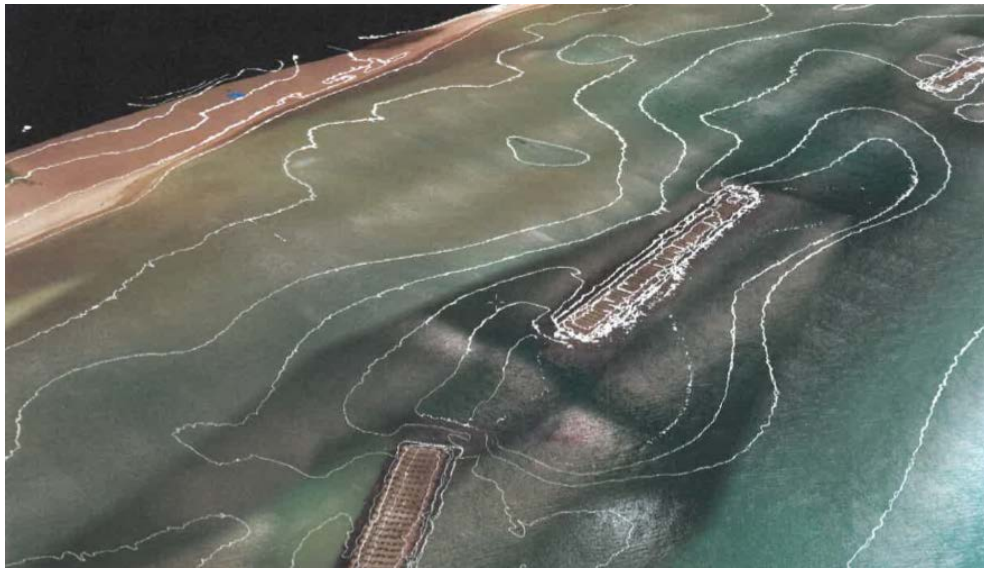
図 4.16 浅海域グリーンレーザーによる離岸堤周囲の等深線データ (株式会社パスコ提供)
