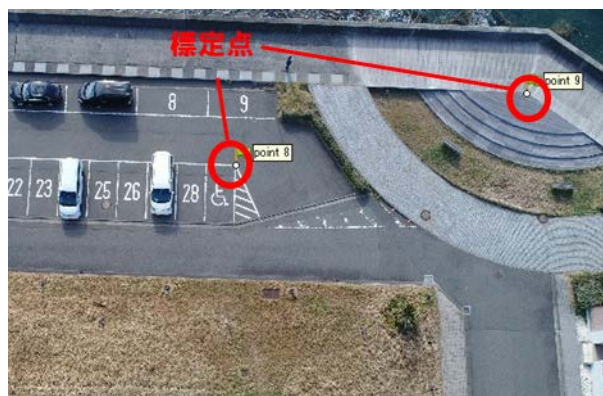
図 4.4 初期アラインメントの後、画像に標定点を設定
