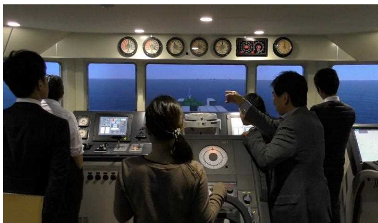
図 4-5 フルミッション操船シミュレータを用いた AI 操船評価
