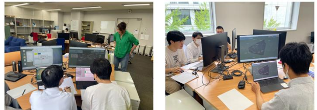
図 ESCAPE Light シミュレータ: 左図の手前は、左からシミュレーション統括席、パイロット卓。右図の手前は、航空路のレーダー管制を模擬した管制卓
