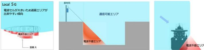
Wi-Fiのsmallセル特性と遮蔽回避性が高いアンテナとファームウェア開発により電波遮蔽エリアの解消
