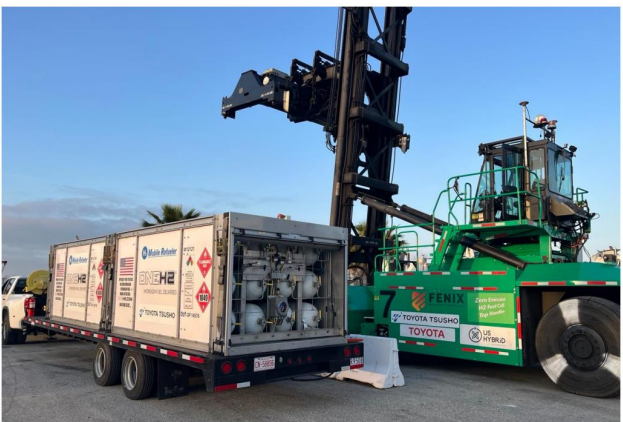
水素燃料電池トップハンドラーと水素供給設備
