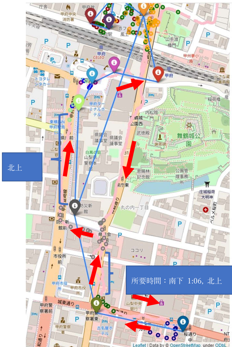
図 5-2 GPS 付周遊端末の位置と各センサに記録された位置。GPS で記録した位置をピンクで、各センサが捕捉したパケットの発信地をそれぞれのセンサと同一色で表示。
