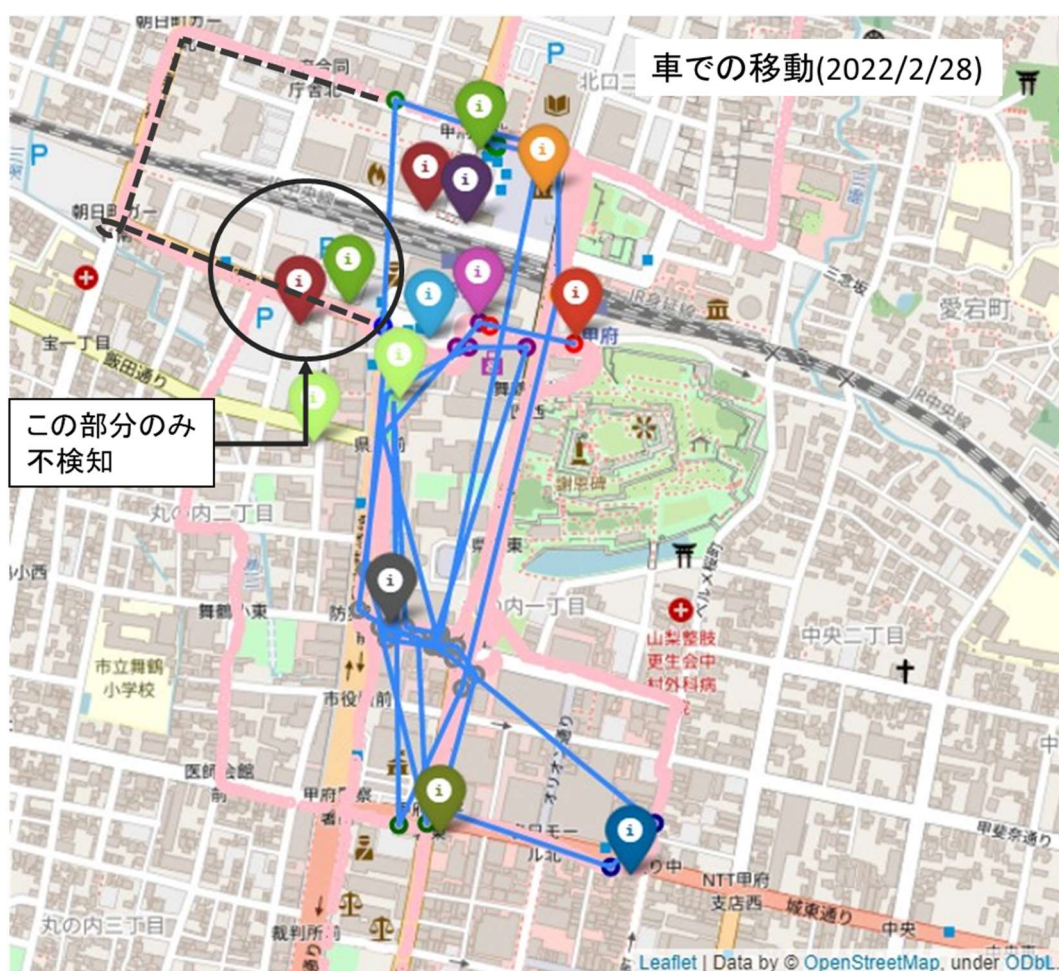
図 5-3 車で移動した端末のセンサによる経路捕捉の実験例
