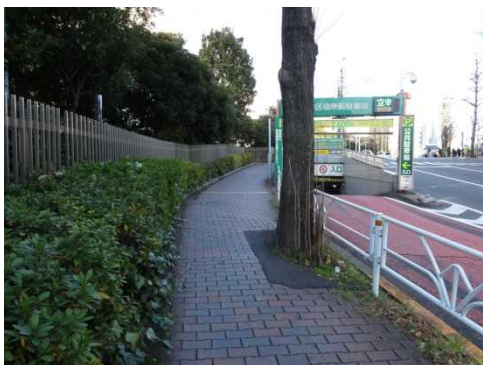
図3. 3 車道と歩道の物理的な分離ありの例
