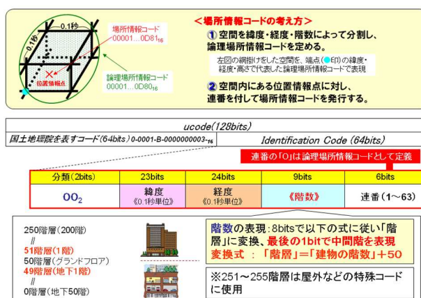
図3. 2 場所情報コードの仕様の概略
