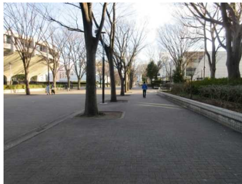
図3. 3 車道と歩道の物理的な分離ありの例
